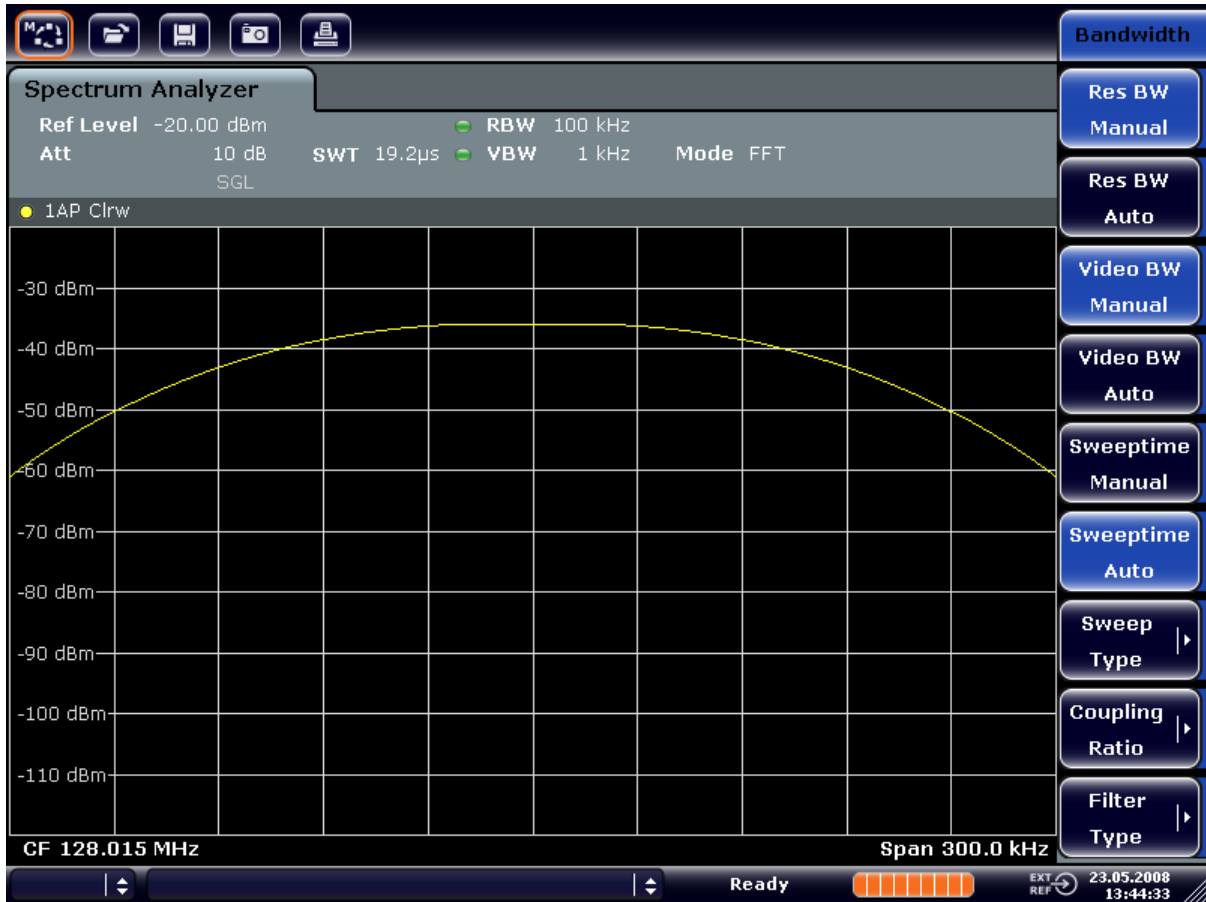
그림 6-5: RBW 이 주파수 추출 간격보다 더 큰 두 개의 균등 RF 정현 신호 측정
