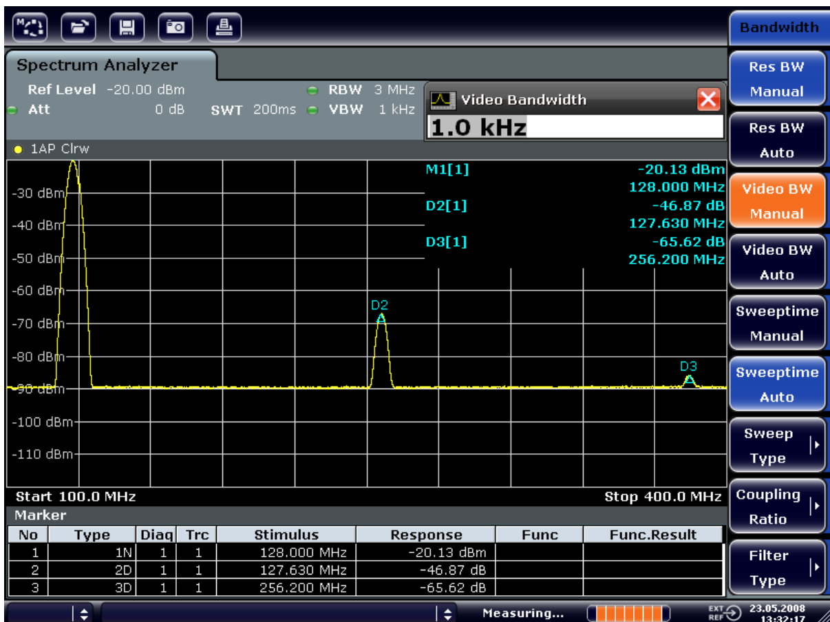
그림 6-3: 하모닉스 측정 시 VBW 을 줄여 잡음 제거하기
